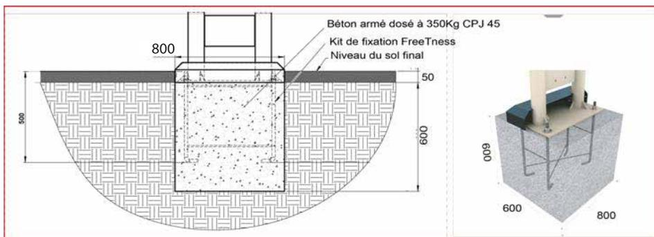
Effectuer les fouilles selon le plan (800mm x 600mm x 600mm). Positionner le kit de fixation dans le béton frais après vérification de celui-ci (voir page suivante). Laisser dépasser de 5cm les tiges filetées. Vérifier le niveau du plot béton et du kit une fois celui-ci placé dans le béton. Essuyer les projections de béton sur le filetage utile.
